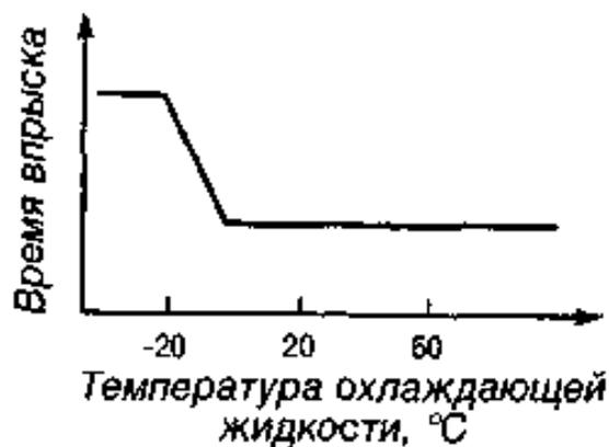
Рис. 1.14. Время впрыскивания топлива при пуске двигателя
